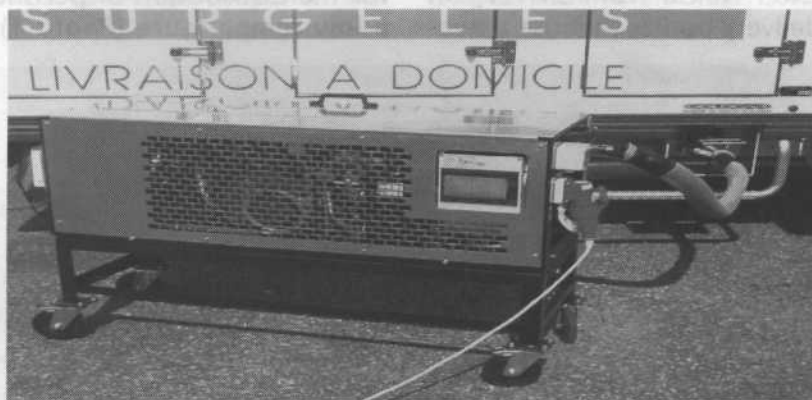
Photo 6. Split system Système split
